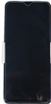
図のように、マグネットクランプの向きを確認し、スマートフォンの中央付近に配置してください。
