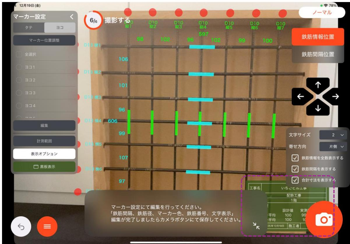
⑤下図に示すとおり、全長と計測箇所数から平均間隔の計測値が算出され、小黒板に反映されます。
